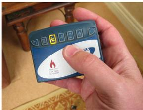
Der Pager ist klein, leicht und unauffällig. Er passt in die Hosentasche oder kann am Gürtel getragen werden. Wenn der Pager ein Signal empfängt, vibriert er und eine dem ausgelösten Alarm zugeordnete Taste leuchtet auf, um den Benutzer zu alarmieren.
