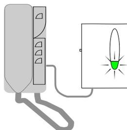
Aktivieren Sie die Türsprechanlage und überprüfen Sie ob der Alarm ausgelöst wird.
