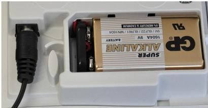
Es wird empfohlen, dass wenn das Stromkabel benutzt wird, keine Batterie eingelegt ist. So kann das Babyfon einfach ausgeschaltet werden, indem man das Stromkabel herauszieht. Falls eine Batterie mit oder ohne Stromkabel verwendet wird, muss der Empfindlichkeitsregler ausgeschaltet werden und wenn er benötigt wird, wieder eingeschaltet werden.
