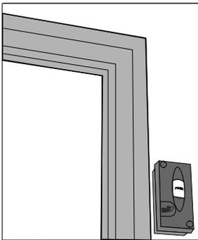
Entfernen Sie die Schraubenabdeckungen & befestigen Sie den Mini Sender mit Hilfe der mitgelieferten Schrauben am Türrahmen oder der benachbarten Wand.
