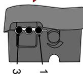
Stellen Sie sicher dass die Hauptleitung (negativ) in die Eingangsbuchse 1 eingesteckt ist, um falschen Alarm zu vermeiden.
