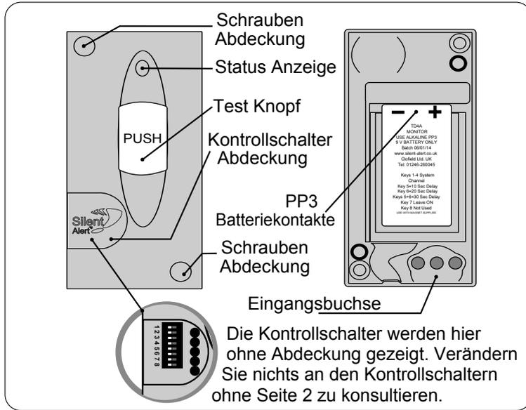
1. Legen Sie eine 9 Volt PP3 Alkali Batterie oder eine Lithium Batterie ein. Beachten Sie dabei die korrekte Polarität.
