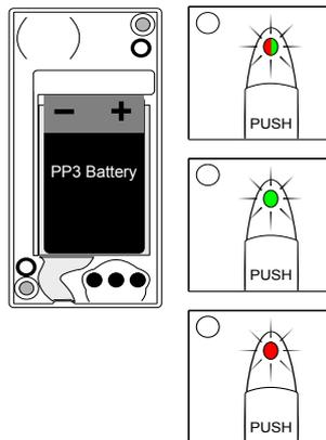
Wenn die Batterie das erste Mal eingelegt wird, blinkt die Statusanzeige einige Male zunächst rot, dann grün. Daraufhin wird die Anzeige sooft grün blinken, wie die vorhandene Batterie Volt hat. 9mal blinken = 9 Volt in der Batterie
