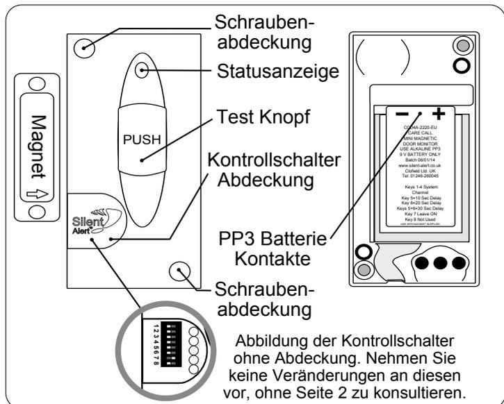
1. Legen Sie eine 9 Volt PP3 Alkali Batterie oder eine Lithium Batterie ein. Beachten Sie dabei die korrekte Polarität.
