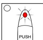
Drücken und halten Sie den Test Knopf gedrückt, bis das Licht rot blinkt, dann lassen Sie ihn wieder los. Das schaltet den Türsender aus.
