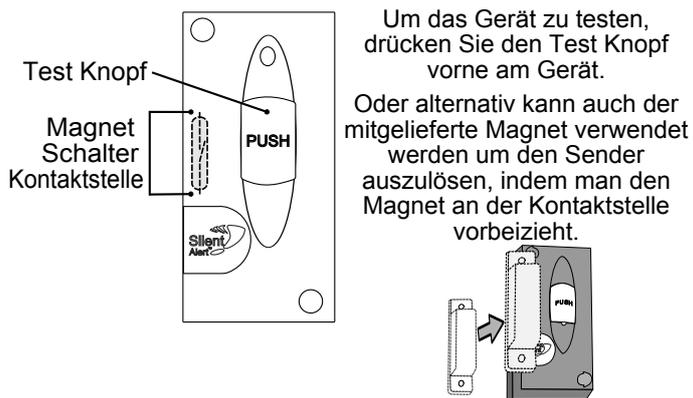
Um das Gerät zu testen, drücken Sie den Test Knopf vorne am Gerät.
