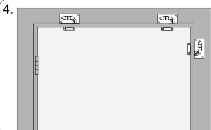
Wir empfehlen den Türsender auf der gegenüberliegenden Seite der Türangel zu montieren. Der Magnet muss nicht in der Nähe der Magnet Schalter Kontaktstelle sein, wenn die Tür geschlossen ist, da der Türsender nur ausgelöst wird, wenn der Magnet an der Kontaktstelle vorbeigezogen wird.
