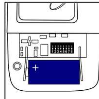
Tauschen Sie die Batterie aus gegen eine 6Volt Lithium Batterie (2CR1/3N oder PX28L).
