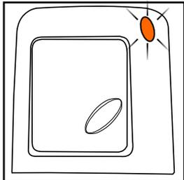
Wenn das Licht orange leuchtet, wenn man den Senden Knopf drückt, bedeutet das, dass die interne Batterie schwach ist und ausgetauscht werden sollte. (Siehe Schritt 3).
