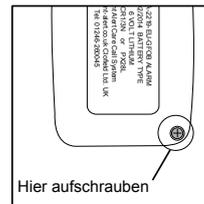
Falls die Batterie ausgetauscht werden muss, drehen Sie die Schraube auf der Rückseite des Gerätes heraus. Drehen Sie das Gerät um und drücken Sie vorsichtig die Batterieabdeckung nach oben, so dass Sie die Batterie und die Kontrollschalter sehen können.
