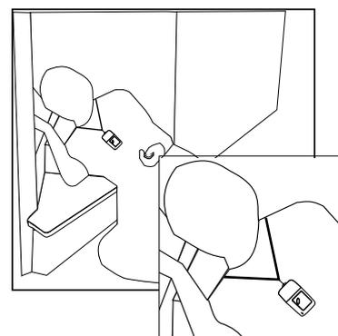
Um ein möglichst genaues Ergebnis zu erhalten, empfehlen wir die mitgelieferte Umhängekordel um den Hals zu tragen. Durch das Tragen des Senders in der Tasche reduziert sich die Effektivität der Erschütterungserkennung.
