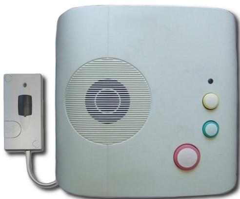
Die DDA Sets lassen sich einfach mit Telecare Kommunikatoren verbinden, die so programmiert werden können, dass sie den Pager oder SignWave auslösen, wenn ein eingebauter Rauchmelder aktiviert wird.
