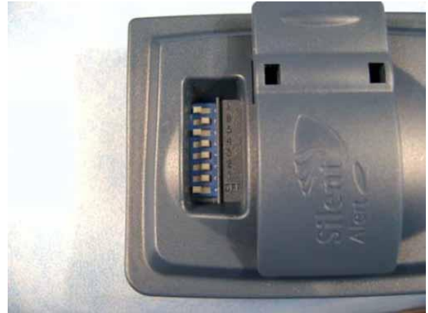
Pager Unterseite zeigt die Kontrollschalter
