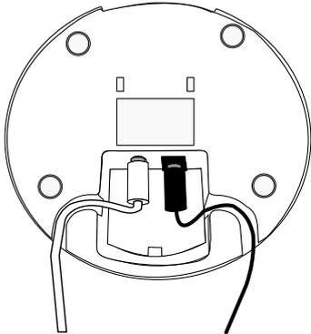
Stecken Sie das Stromkabel in das Gerät und den Stecker in die Steckdose ein. Nun muss die vibrierende Kissenunterlage angebracht werden, wenn sie verwendet wird.
