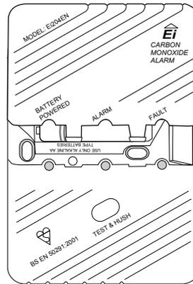
Schieben Sie den Deckel des Batteriefaches zur Seite und nehmen Sie ihn ab.
