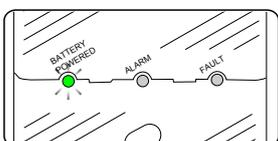
Falls die Batterie schwach ist, fängt das Gerät an zu zirpen, ein Signal wird an Pager oder SignWave gesendet und die Batterieanzeige leuchtet grün alle 45 Sekunden.
