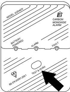
Drücken und halten Sie den Test Knopf gedrückt. Der Alarmton wird abgegeben und ein Signal wird zum Pager oder SignWave Empfänger gesendet.
