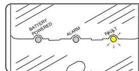
Wenn eine Elektronikstörung auftritt informiert das Gerät Sie indem es zirpt, ein Signal an den Pager oder SignWave sendet und die Störungsanzeige leuchtet orange. Das Gerät muss ausgetauscht werden.
