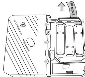
Entfernen Sie den Batteriestreifen indem Sie nach außen und weg vom Gerät ziehen.
