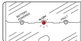
Wenn das Gerät Kohlenmonoxid entdeckt, geht der Alarm los, ein Signal wird zum Pager oder SignWave Empfänger gesendet und die Statusanzeige leuchtet rot.
