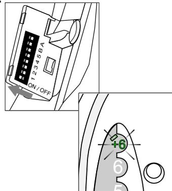
Bewegen Sie den An/Aus Schalter nach links mit Hilfe des Deckels der Vorderabdeckung.
