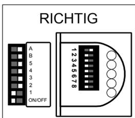
Hier haben wir einen Care Call SignWave und Mini Sender auf Kanal 2 eingestellt. Beim Einstellen der Kanäle müssen Sie dran denken den **An/Aus** Schalter am SignWave zu ignorieren, ansonsten sind die Geräte auf versch. Kanäle eingestellt. Die Abbildung rechts zeigt einen falschen Einstellungsversuch des Kanals 2 (als Beispiel gezeigt um eventuelle Verwirrung zu vermeiden). Die richtige Einstellung sehen Sie links.
