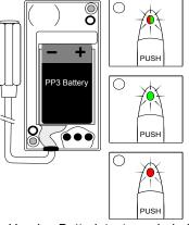
Wenn die Batterie das erste Mal eingelegt wird, blinkt die Statusanzeige einige Male zunächst rot, dann grün.
