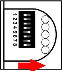
Entfernen Sie die Kontrollschalter Abdeckung mit Hilfe eines flachen Schraubenziehers. KSchalter Nr.7 ist bereits angeschaltet und darf **NICHT** ausgeschaltet werden.
