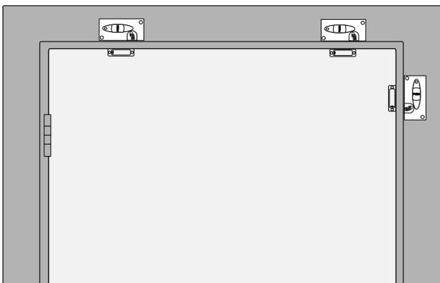
Wir empfehlen den Türsender auf der gegenüberliegenden Seite der Türangel zu montieren. Der Magnet muss nicht in der Nähe der Magnet Schalter Kontaktstelle sein, wenn die Tür geschlossen ist, da der Türsender nur ausgelöst wird, wenn der Magnet an der Kontaktstelle vorbeigezogen wird.
