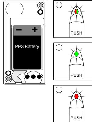
Wenn die Batterie das erste Mal eingelegt wird, blinkt die Statusanzeige einige Male zunächst rot, dann grün.
